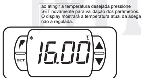
Pressione **SET** até aparecer **Set** na tela, solte e aparecerá a temperatura regulada, pressione as teclas ▲▼ para ajustar a temperatura entre 8° e 18 °C, pressione **SET** novamente e a temperatura estará ajustada.
